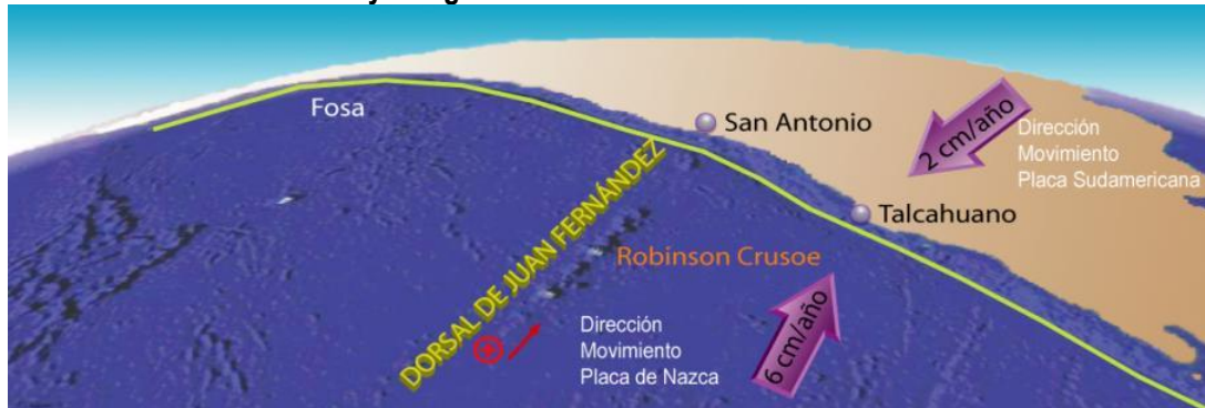
FIGURA N° 3-1 Vista en 3D donde se representa el marco geodinámico, se aprecia la Dorsal de Juan Fernández y el lugar donde es subductada frente a los 33° S.
